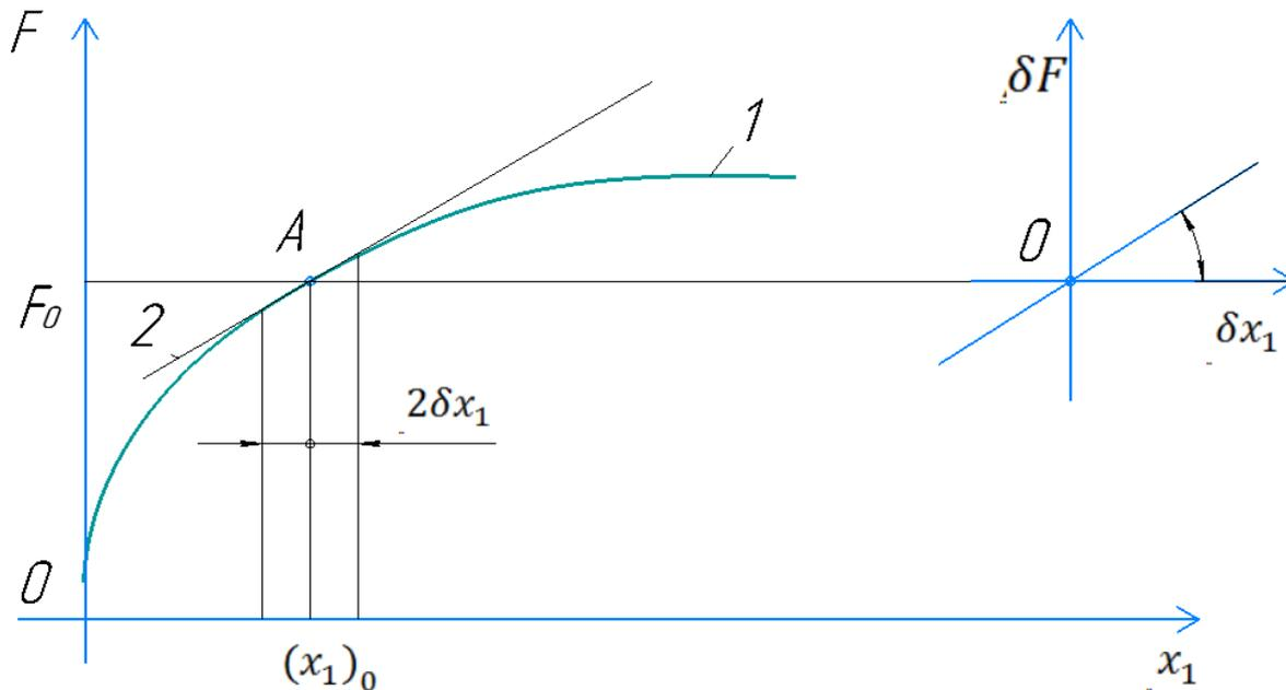
Рис. 2.2. Графическая иллюстрация метода линеаризации
